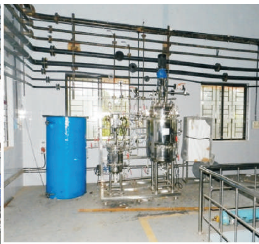
Fig. 200 L Fermenter for bioethanol production
